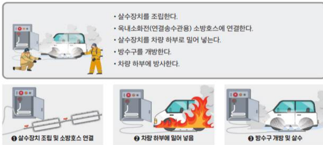
<그림 16> 상방향 살수장치 사용요령
